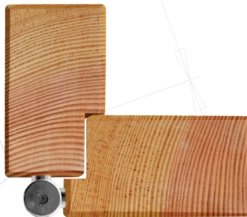
СХЕМА УСТАНОВКИ ПЕТЛИ С ФАЛЬЦЕМ НА ПОЛОТНЕ
