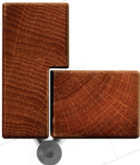
СХЕМА УСТАНОВКИ ПЕТЛИ С ПЛОСКИМ ТОРЦОМ
